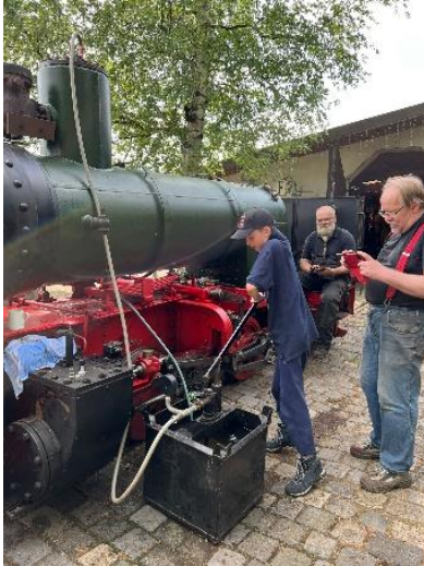
Unsere jungen Mitglieder packen unter Aufsicht auch schon mit an. (Hydrostatischer Test des Dampfkessels): Vorbereitung der Äußeren Prüfung durch die ZÜS (früher TÜV)
